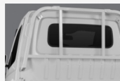
Thanh cản đảm bảo an toàn khi xảy ra va chạm cho cabin từ phía sau.
